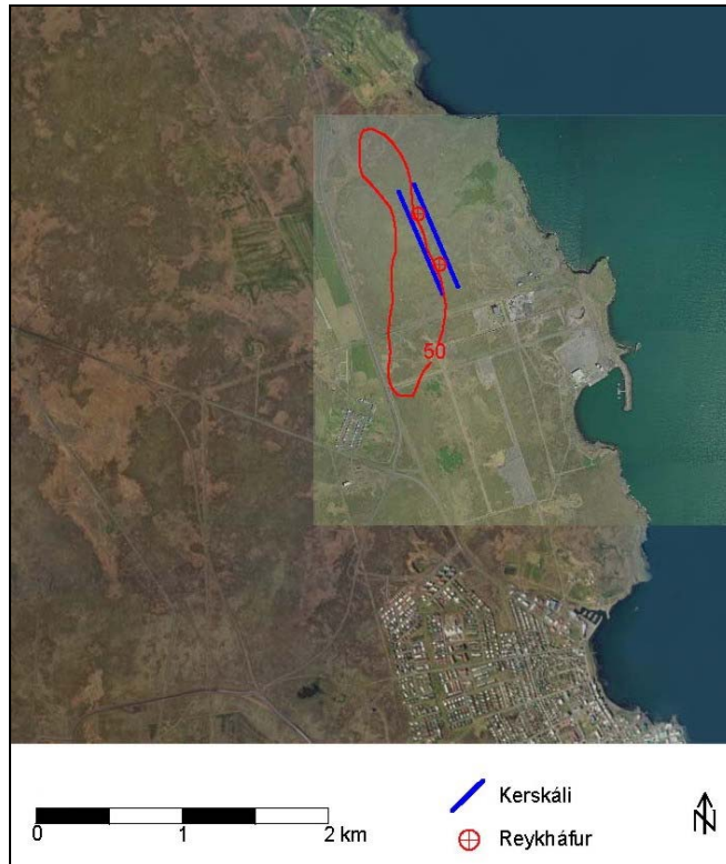
Mynd 15.2 Reiknaður sólarhringsstyrkur \text{SO}_2 ( \mu\text{g}/\text{m}^3 ) með þurrhreinsun. Umhverfismörk eru 50 \mu\text{g}/\text{m}^3 miðað við 98% líkindi.
